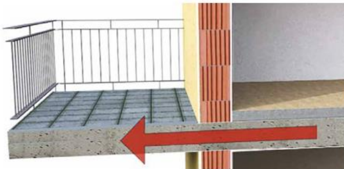
massive Wärmebrücke: durchgehend betonierte Balkonplatte | © FH Salzburg, Smart Building
