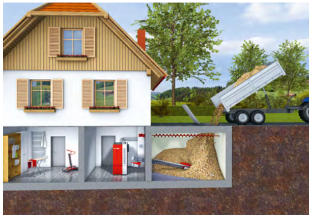
Befüllung eines Hackgut-Lagerraums mittels Fallschacht | © Hargassner GmbH
