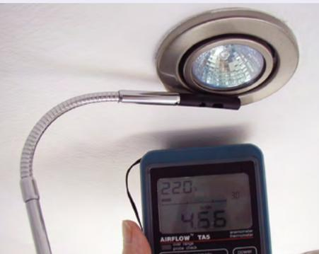
Messung der Luftbewegung bei einer Elektroinstallation.
