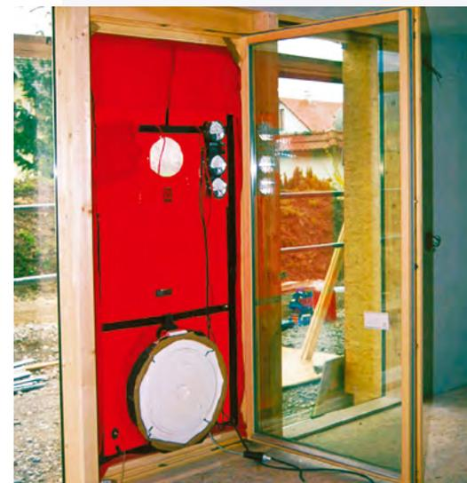
*Eingebaute Blower-Door, der Ventilator befindet sich unten.*
