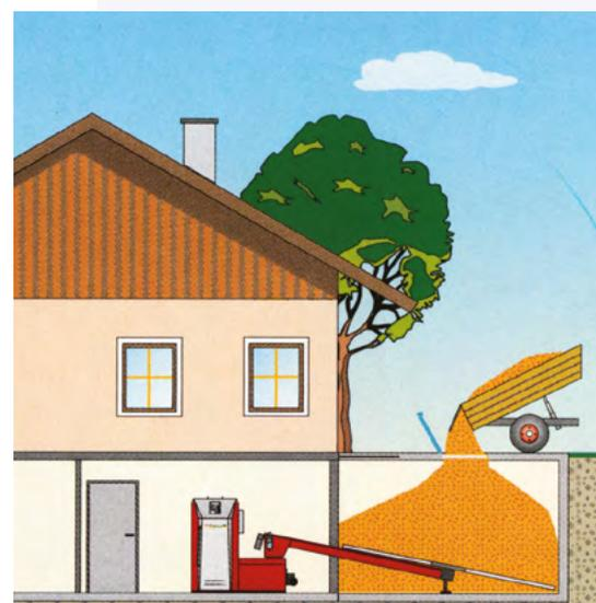
Einfaches Nachfüllen des Hackgutes durch außen liegenden Lagerraum, von oben befüllbar.
