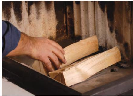
Das Stückholz für eine ausreichende Luftzufuhr locker in den Brennraum schichten.
