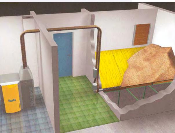
*Raumaustragung mit Rohrsaugsystem: Der Lagerraum muss nicht neben dem Kesselraum liegen.*
